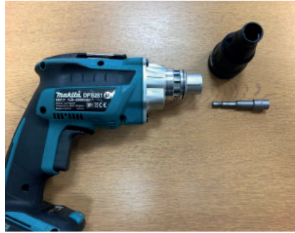
Fjern dybdestopp og bitholder.
