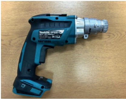
Monter QD-adapter, slik at den sitter helt tilbake mot maskinen.
