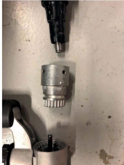
Adapteren plasseres på spissen og skyves helt inn, og festeskrue strammes.
