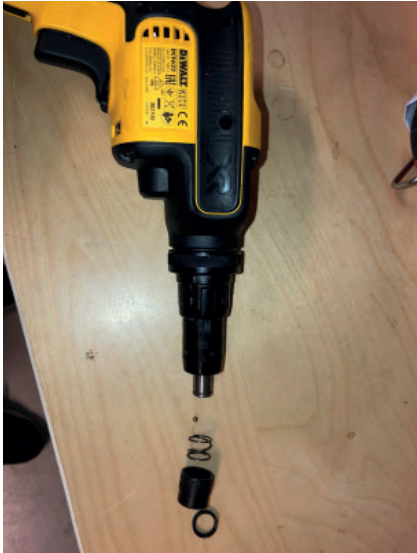
Fjern O-ring på spissen. Det er enklest å gjøre med en syl eller et spiss gjenstand.
