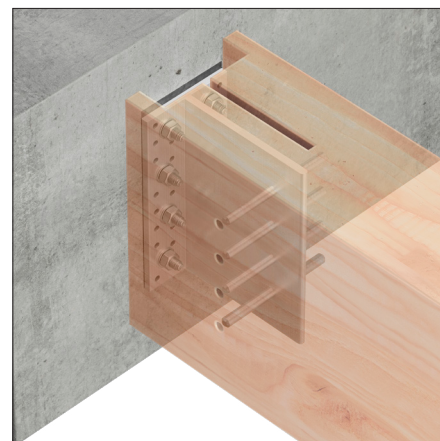
BTCALU festet til betong ved hjelp av FM753 eks.bolt og med SDD-dybler installert gjennom finnen
