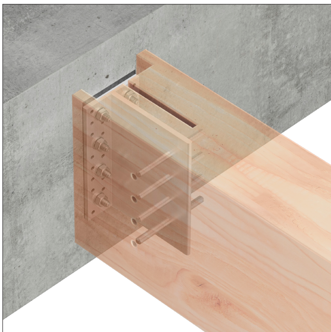
BTALU-montering fra tre til stiv understøttelse. Merk bruken av polyetylentape med lav tetthet mellom beslaget og betongoverflaten.
