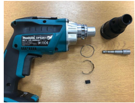
Sørg for å fjerne alle metallringer og gummideler.
