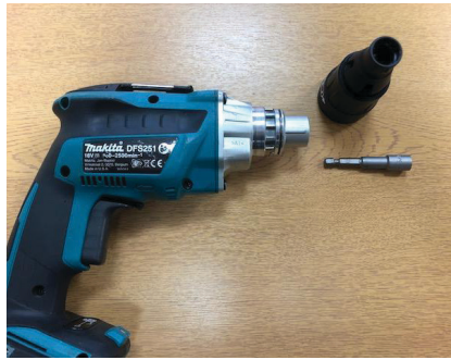
Fjern dybdestopp og bitholder.
